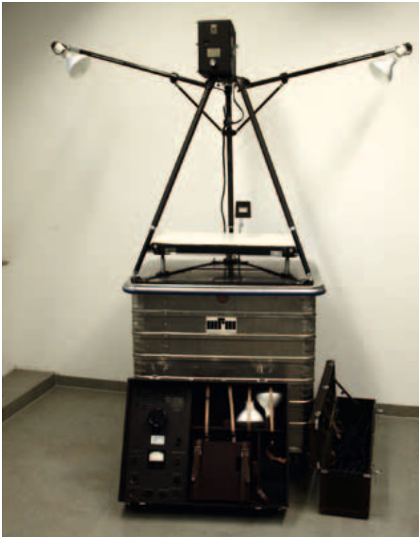
Transportable Mikrofilmkamera vom Typ KODAK Modell E, der Deckel des Transportkoffers diente als Aufnahme­fläche.
