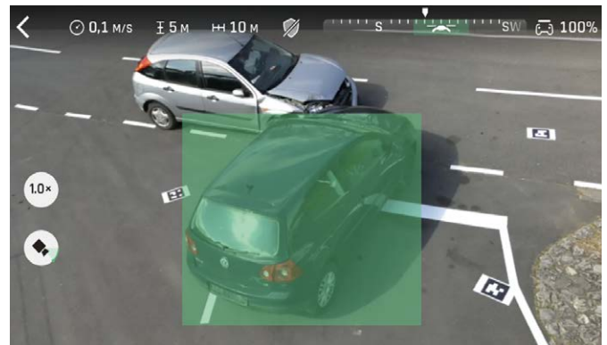
Abbildung 2: AMICA: Automatische Bilderkennung von Verkehrsunfällen mittels KI-Algorithmen.
